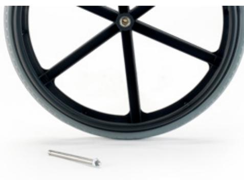
Eje de desmontaje rápido para ruedas traseras
